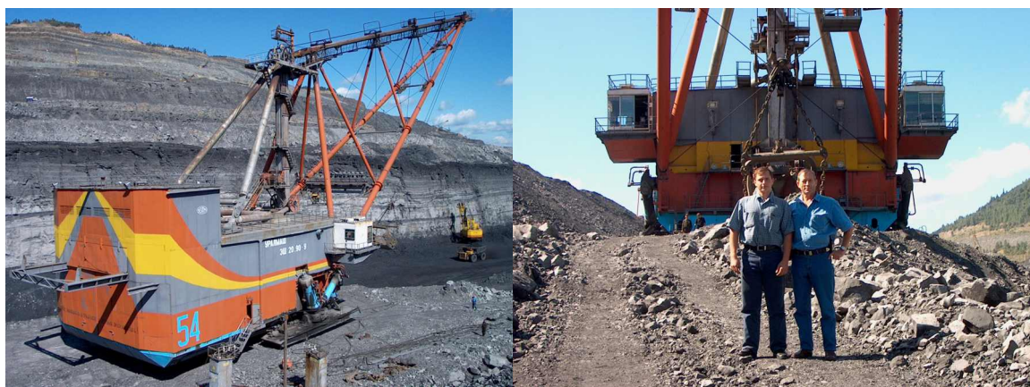
ЭКСКАВАТОР ЭШ 20/90 № 54 В РАБОТЕ
