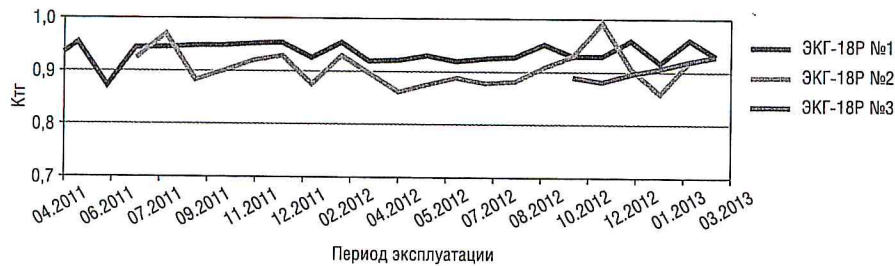
Рис. 3 Динамика коэффициента технической готовности экскаваторов ЭКГ-18Р
