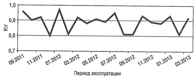
Рис. 4 Коэффициент технической готовности экскаватора ЭКГ-32Р
